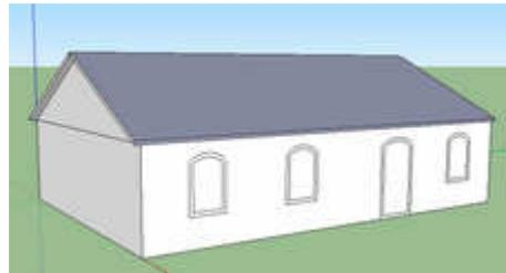
Avec l'outil Tirer-Pousser, extruder les 4 ouvertures vers l'intérieur de 0,2 m (épaisseur des murs)
